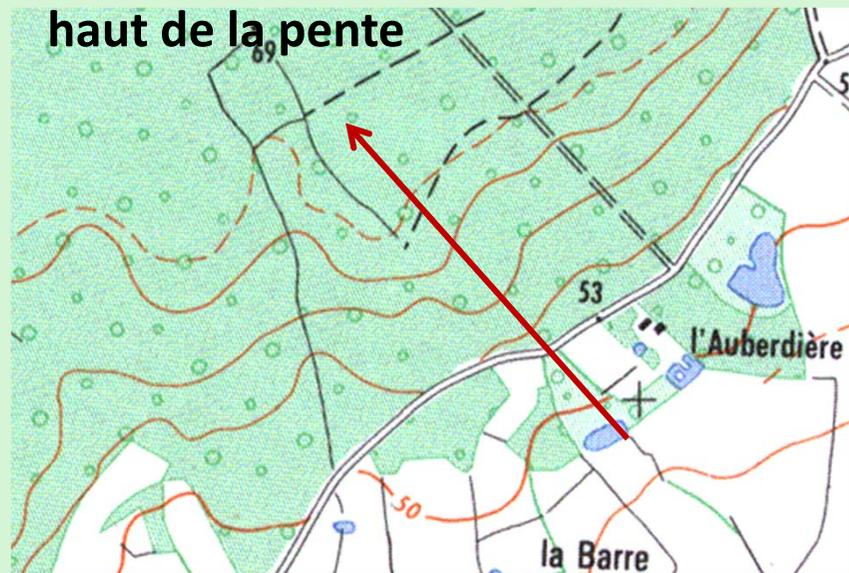
**L'orientation de l'altitude indiquée sur les courbes maîtresses suffit à indiquer le haut de la pente**
